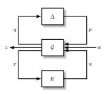
$$\begin{bmatrix} x \\ y \\ z \end{bmatrix} = \begin{bmatrix} A & B_p & B_w & B_u \\ C_q & D_{qp} & D_{qw} & D_{qu} \\ C_z & D_{zp} & D_{zw} & D_{zu} \end{bmatrix} \begin{bmatrix} x \\ p \\ w \\ u \end{bmatrix}$$
